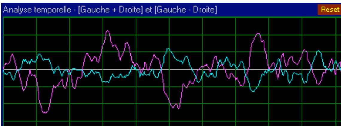
Ces deux courbes, complémentaires de celles des voies Gauche et Droite, sont particulièrement utiles pour apprécier l'image stéréo et/ou le déphasage entre les deux voies Gauche et Droite.
